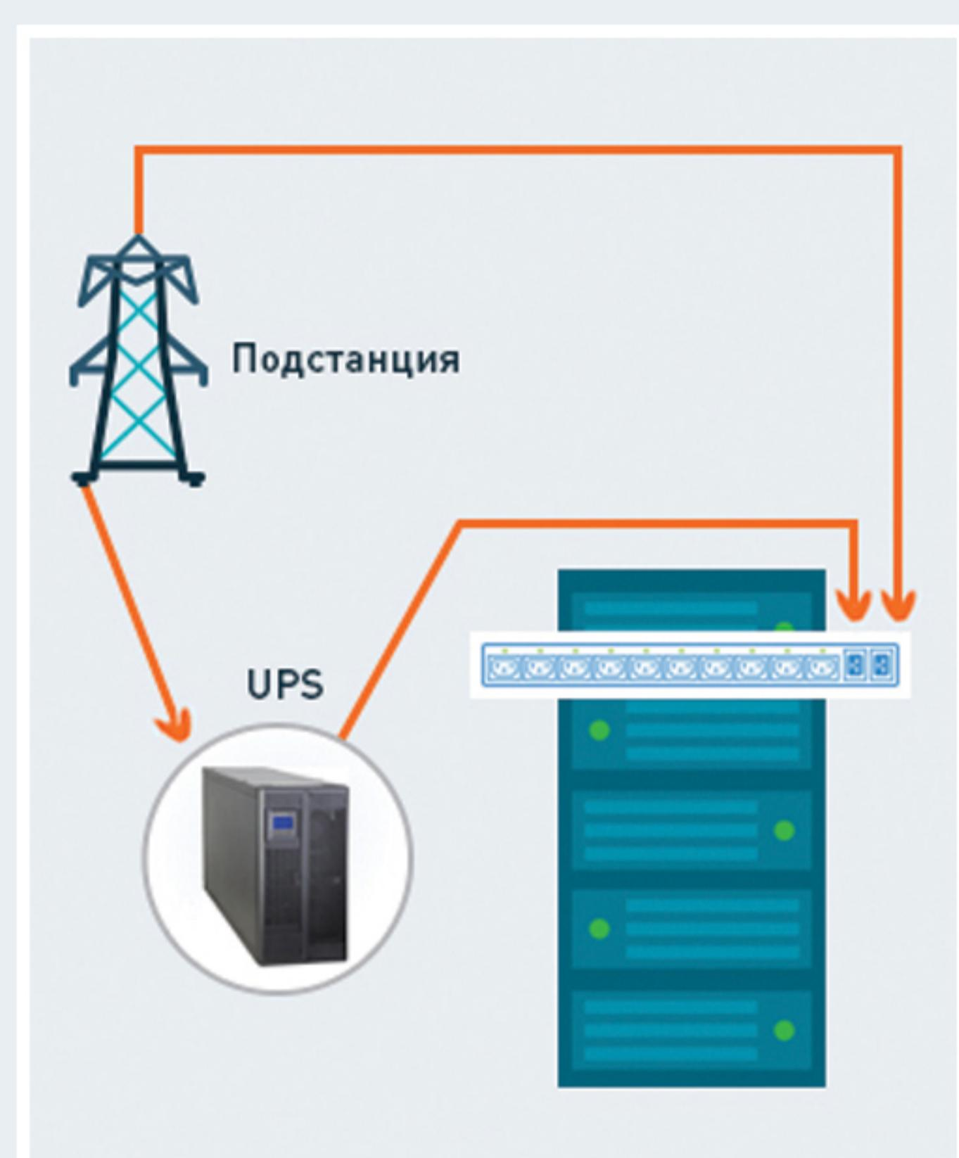
Электропитание в современных ЦОД обычно обеспечивается 2 независимыми вводами, каждый из которых защищён своими источниками бесперебойного питания ИБП (UPS) и дизель-генераторными установками ДГУ (Dieselgen) или дизельными роторными ИБП-системами ДРИБП (DRUPS).
