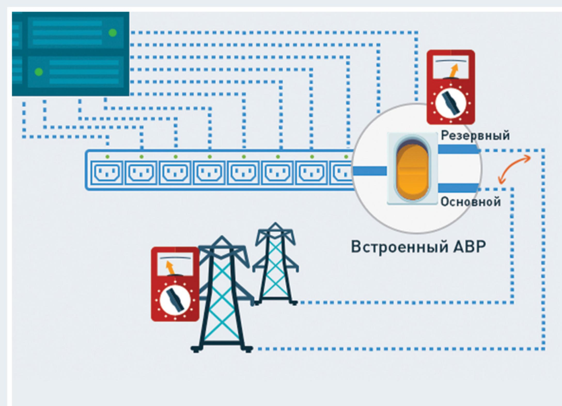
двух управляемых PDU в совокупности в разы выше, чем использование оборудования с одним блоком питания совместно с RPCM, в котором есть функция АВР и управление питанием выводов.
